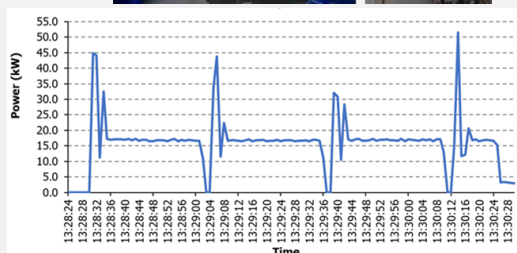
Máy nhuộm/giặt không có VFD
